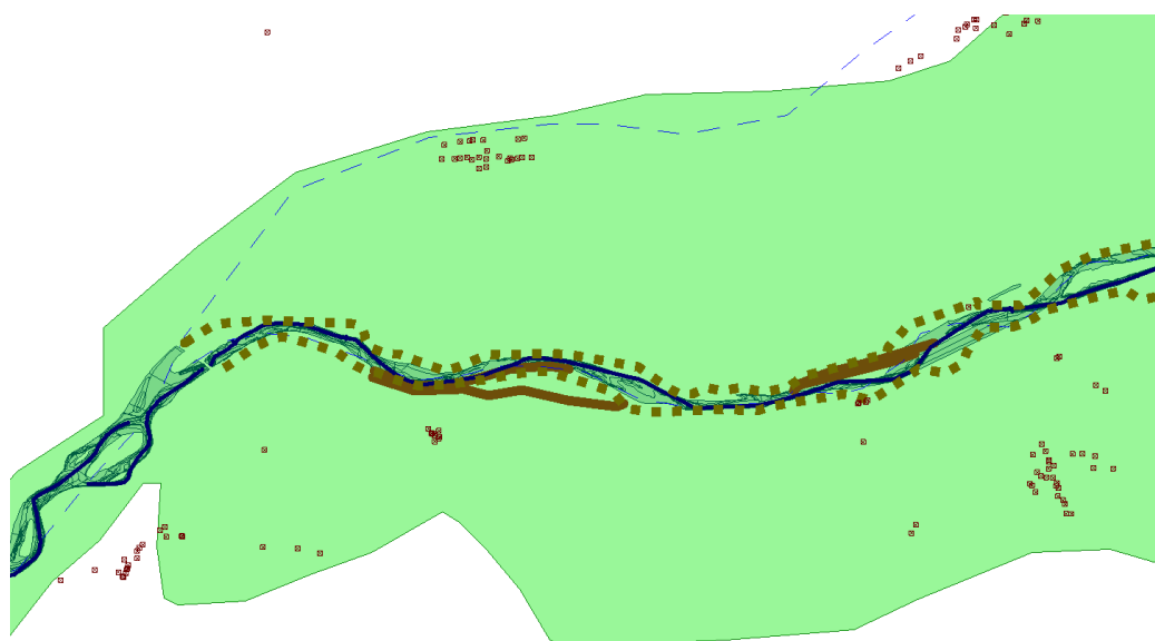
Рис. 5. Просмотр объектов попадаемых в зону затопления при паводках 5% обеспеченности
