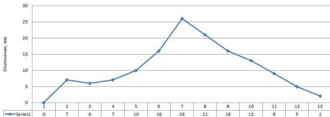
Рис. 6. График изменения отметки высоты окрайки резервуара
