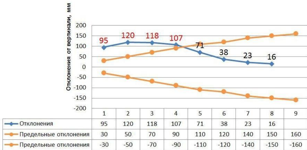
Рис.5. Оценка наклона резервуара по вертикальным поясам
